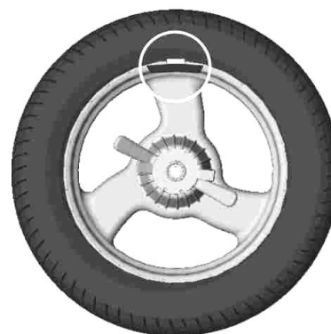
б - груз установлен в положение «12 часов»
