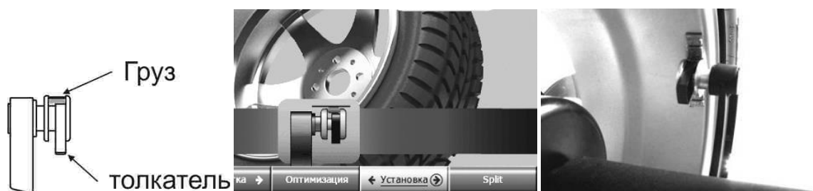
Рисунок 5.13 – Установка груза линейкой
