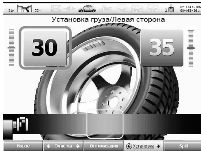
Рисунок 5.12 – Экран при установке груза линейкой
