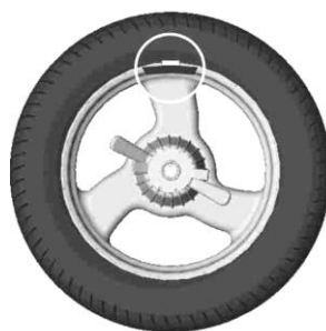
Рисунок 6.6 - Груз установлен в «12 часов»
