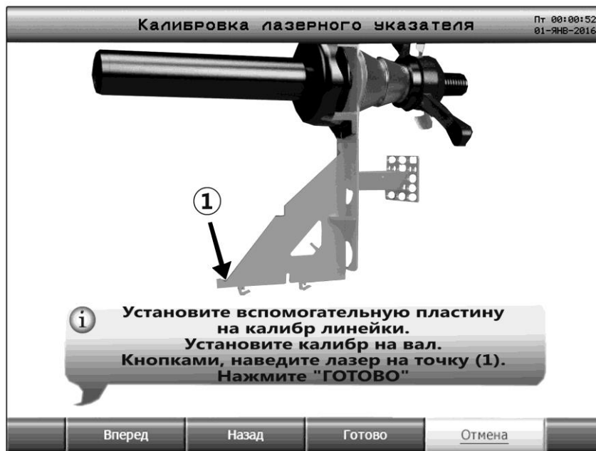
Рисунок 8.7 – Окно калибровки лазерного указателя
